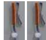
Thermistor x2 (Refrigerant: E1, E2)
